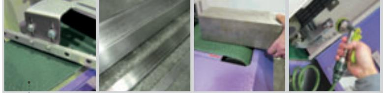
LUFTMESSER ZUM ENTFERNEN VON WASSER
