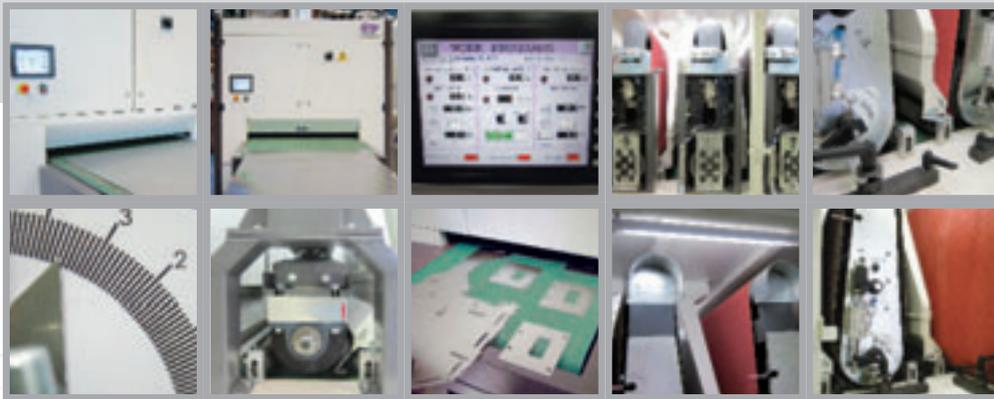
*Die oszillierende Bürste gestattet Schleifen von Oberflächen und Entgraten von Teilen*
