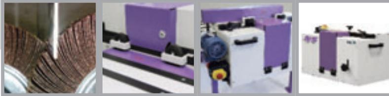
Doppelte Arbeitsposition: horizontal und vertikal
